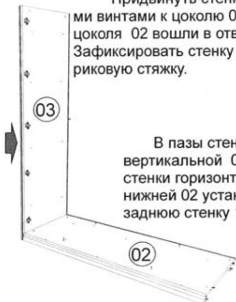
В пазы стенки вертикальной 03 и стенки горизонтальной нижней 02 установить заднюю стенку 15.
