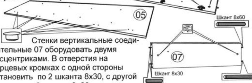
Придвинуть стенку вертикальную 03 соединительными винтами к цоколю 02. Обратить внимание, чтобы шканты цоколя 02 вошли в отверстия стенки вертикальной 03. Зафиксировать стенку 03 к цоколю 02 на эксцентриковую стяжку.
