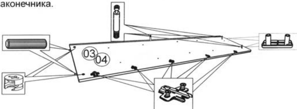
Две стенки вертикальные 05 эксцентриками. В отверстия на верхней кромках установить по 2 шканта 8x30. Стенки вертикальные 05 оборудовать ответными планками Д-0.
