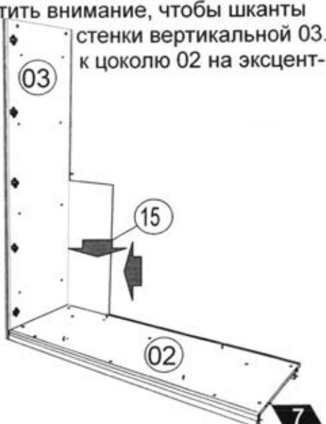
Установить стенку вертикальную соединительную 07 отверстием на соединительный винт стенки вертикальной 03 таким образом, чтобы верхняя кромка задней стенки 15 вошла в паз стенки 07, шканты 8x30 вошли в отверстия на стенке 03. Крепить стенку 07 к стенке 03 на эксцентриковую стяжку.
