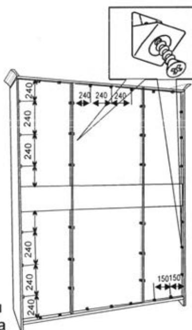
Согласно приведенной выше схемы закрепить задние стенки к каркасу шкафа на соединители задней стенки с шурупом.
