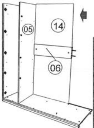
Установить стенку вертикальную 05 отверстиями на соединительные винты стенки горизонтальной 02. Обратить внимание, чтобы шканты стенки вертикальной 05 вошли в отверстия стенки горизонтальной 02, шканты стенки вертикальной соединительной 07 вошли в отверстия стенки 05.
