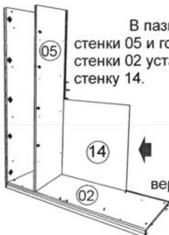
В пазы вертикальной стенки 05 и горизонтальной стенки 02 установить заднюю стенку 14.
