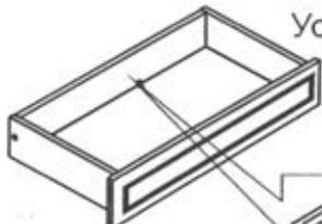
Установить переднюю стенку ящика и зафиксировать на эксцентриковую стяжку. Донья ящиков крепить к ящику на держатели задней стенки.
