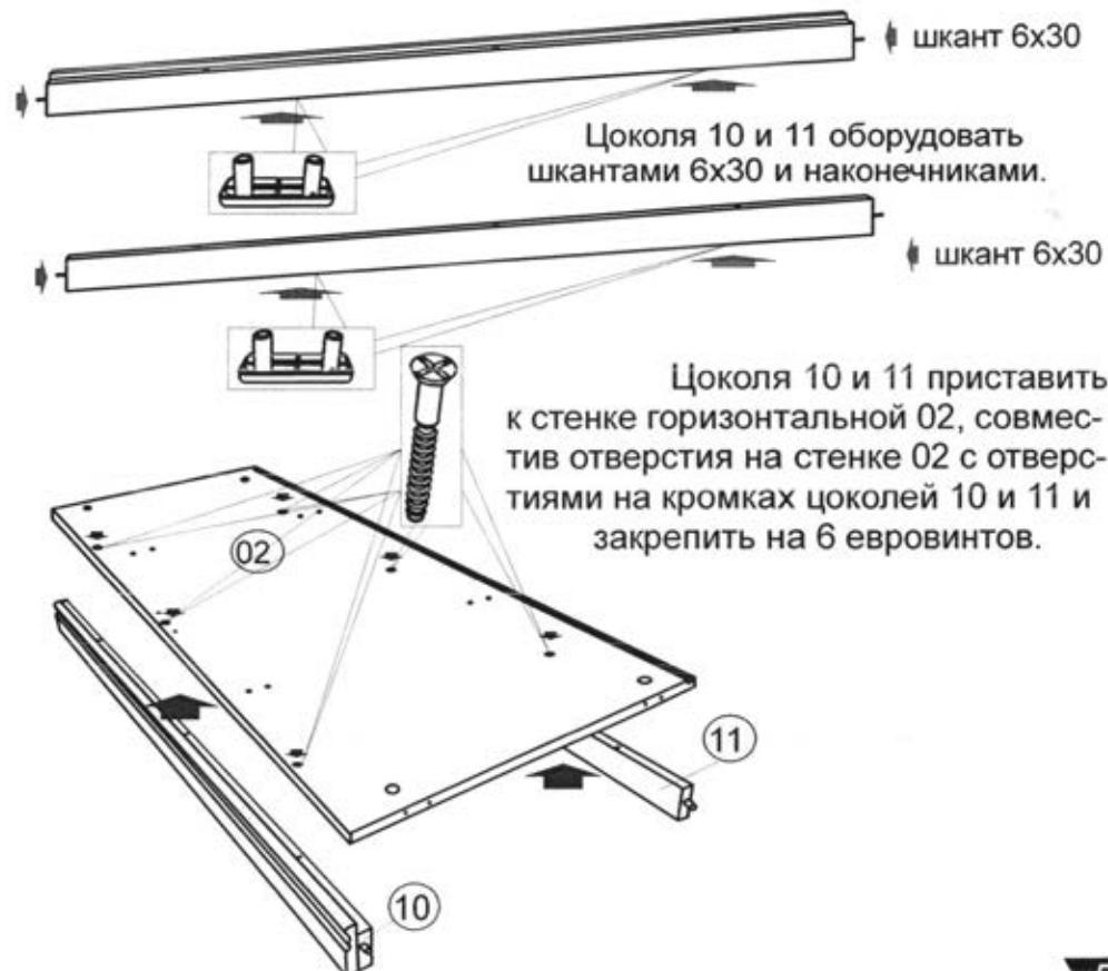
Установить оборудованную цоколями стенку горизонтальную нижнюю 02 в требуемое место и оборудовать ее соединительными винтами и эксцентриками на 16. На евровинты установить заглушки.
