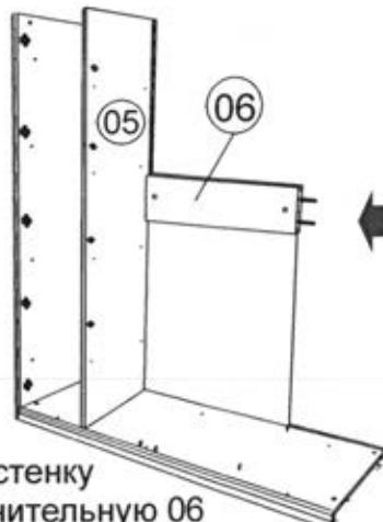
Установить стенку вертикальную соединительную 06 и закрепить на эксцентриковую стяжку.
