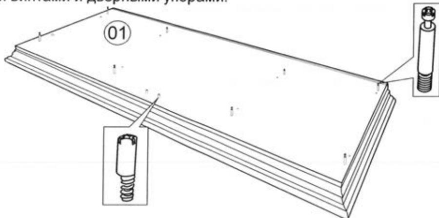
Сверху на каркас шкафа установить стенку вертикальную 01 обеспечив вхождение фурнитуры в отверстия сопрягаемых деталей. Крепить стенку 01 к каркасу шкафа на эксцентриковую стяжку.
